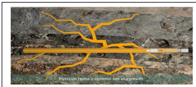
Gráfica 05: Esquema de trabajo de la inyección de resina y/o microcemento a alta presión.
